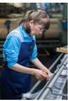
上) 筵に通した経糸を織機にかけるために、手で細かく整えていく。 下) 目にも留まらぬ早さで経糸がまとめられていくようすを興味深く見つめる4人。写真下の白い部分は高速で流れる糸だ
